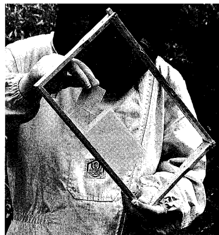
Einsetzen der Verdunstungsfläche aus Papierfilz (Docht)
