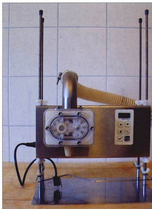
Mit einem auf Volumenbasis arbeitenden Gerät wird das Abfüllen von Honig erheblich erleichtert. Stichprobenartige Kontrollwiegungen mit einer geeichten Waage müssen aber am Anfang und mindestens einmal pro Stunde durchgeführt werden.
