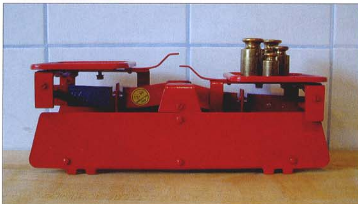
Eine einfache Balkenwaage mit Messinggewichten: Wenn die amtliche Eichung aktualisiert ist, kann sie für Kontrollwägungen benutzt werden.
